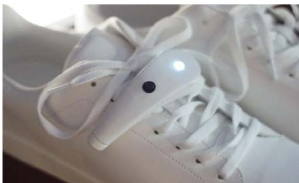
靴に装着できる温度監視デバイスです。赤外線温度センサーで測定したアスファルトの温度に応じてLEDの色が変化します。夏のアスファルトの温度は65℃まで上昇することがあり、愛犬やお子様がお火傷や熱中症にかかる可能性があります。出かける前にWAN-CHANを装着することで、火傷や熱中症に対する注意をユーザーに促すことができます。
